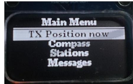
**Achtung während man sich im Menüsystem befindet, sind die meisten Hintergrundaufgaben gestoppt. Diese werden weitergeführt, sobald das Menüsystem wider per ‚Exit‘ verlassen wird. Als Warnung leuchtet die gelbe LED permanent, bis das Menüsystem wieder verlassen wird und der Tracker wieder seine hintergrundaufgaben ausführt.**
