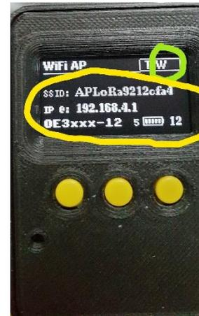
Der Tracker merkt sich bis zu vier WLAN/SSIDs und wird sich zu dem ersten sichtbar und in der Tabelle bekannten WLAN connecten. Es können somit mehrere WLANS (Home, mobiler Hotspot, Auto,etc...) konfiguriert werden.
