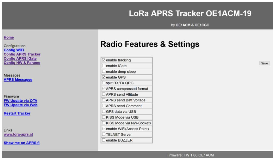
In den Features & Settings Menu werden über Flags bestimmte Programmabläufe zur Steuerung definiert.
